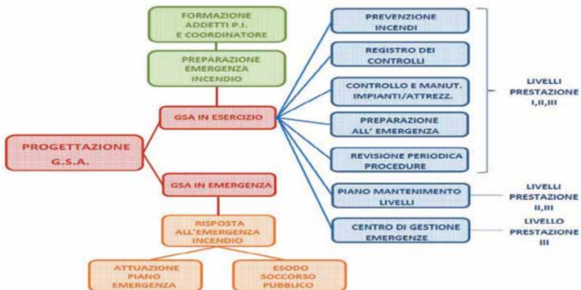
FLOW CHART DELLA GESTIONE DELLA SICUREZZA ANTINCENDIO
