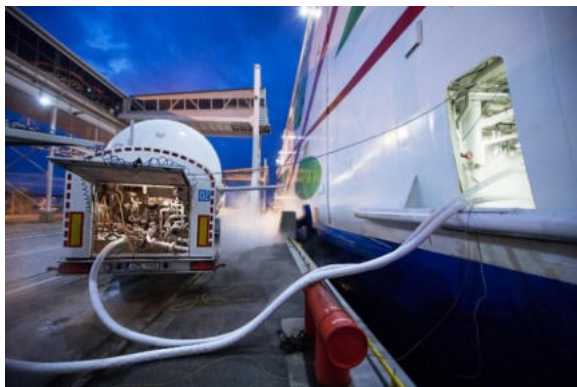
Fig. 4.1: Bunkeraggio TTS (tratto da Linee Guida EMSA)
